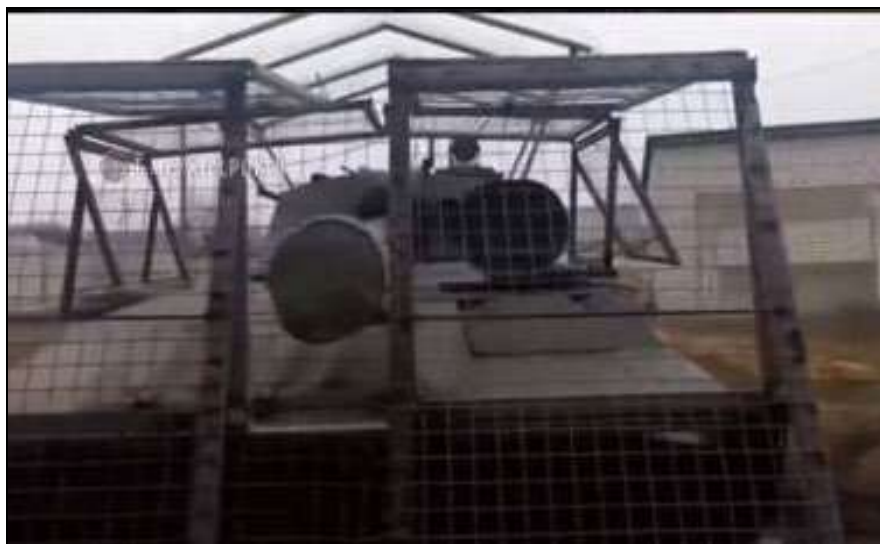
Рис. 9. 122-мм САУ 2С1 «Гвоздика», закрытая сетчатыми экранами
