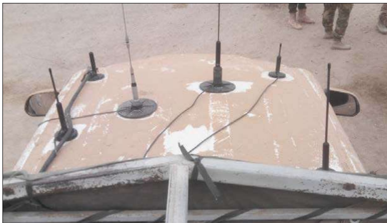
Рис. 12. Размещение станции помех «Лесочек» на капоте автомобиля
